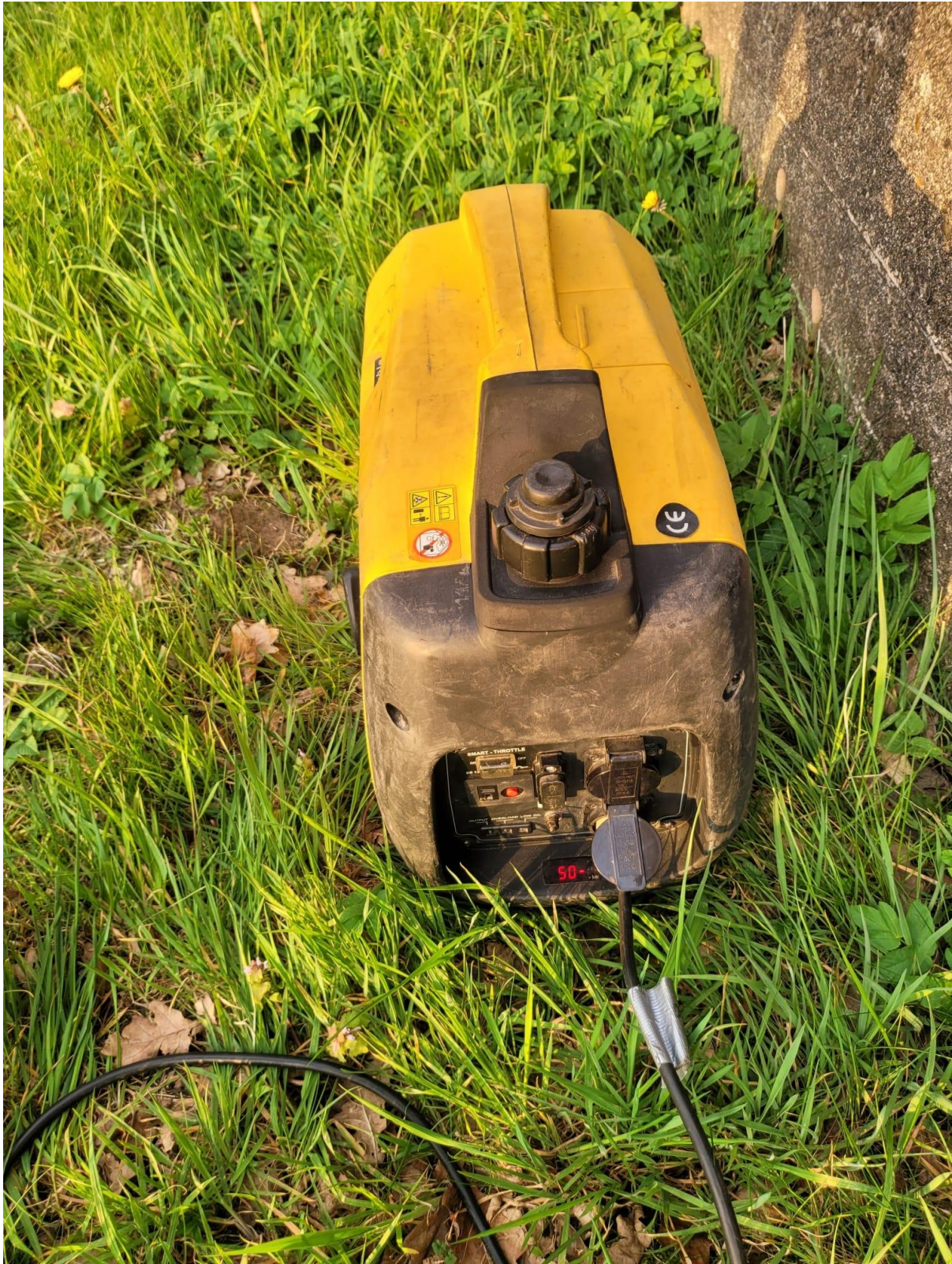
De ontluister boven op de vuldop was ik vergeten te openen, waardoor het ding moeilijk deed en meer dronk
